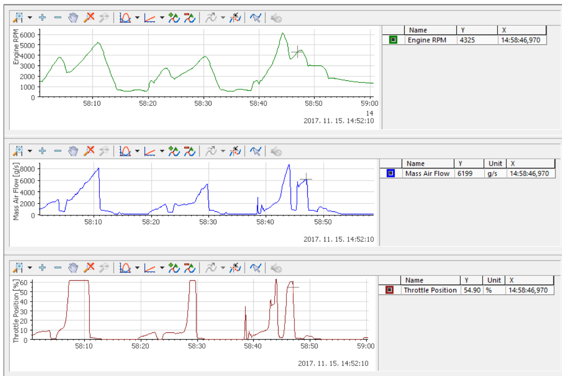
7-31. ábra A fordulatszám, légáram és pillangószelep pozíciójának összefüggése
