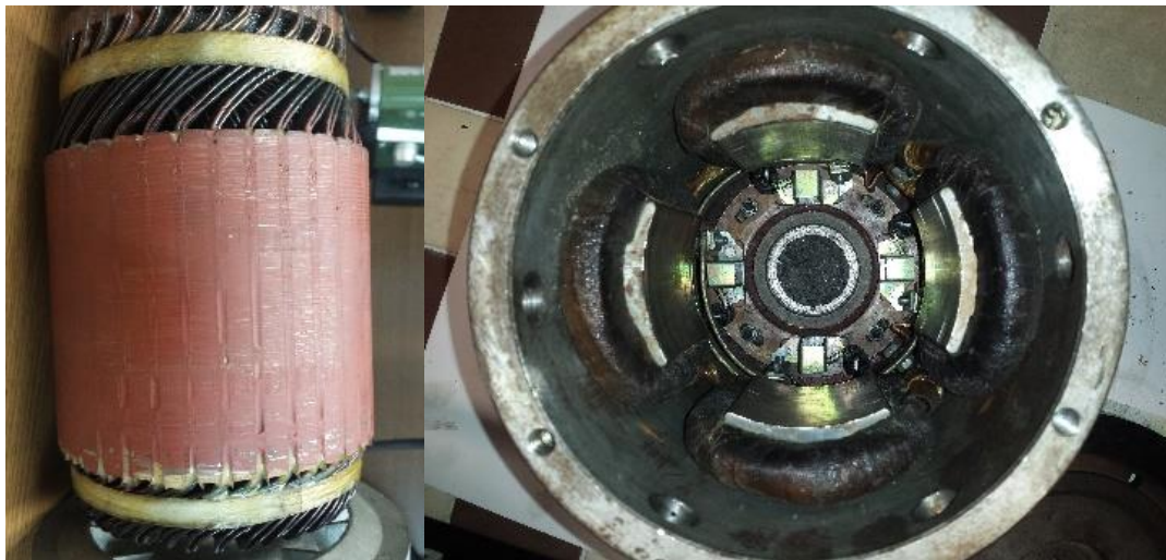
6-1. ábra: A forgórész tekercselése, és az állórész előlnézete.
