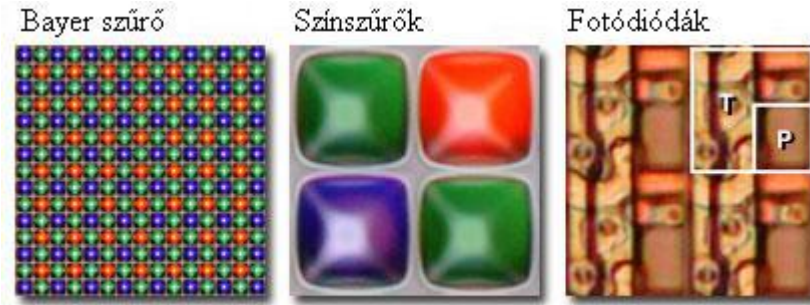
3.4. ábra. A CMOS képérzékelő felépítése.
